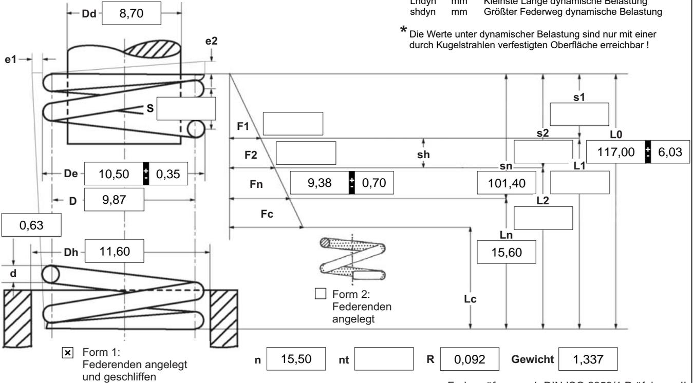
Federprüfung nach DIN ISO 2859/1 Prüfniveau II
