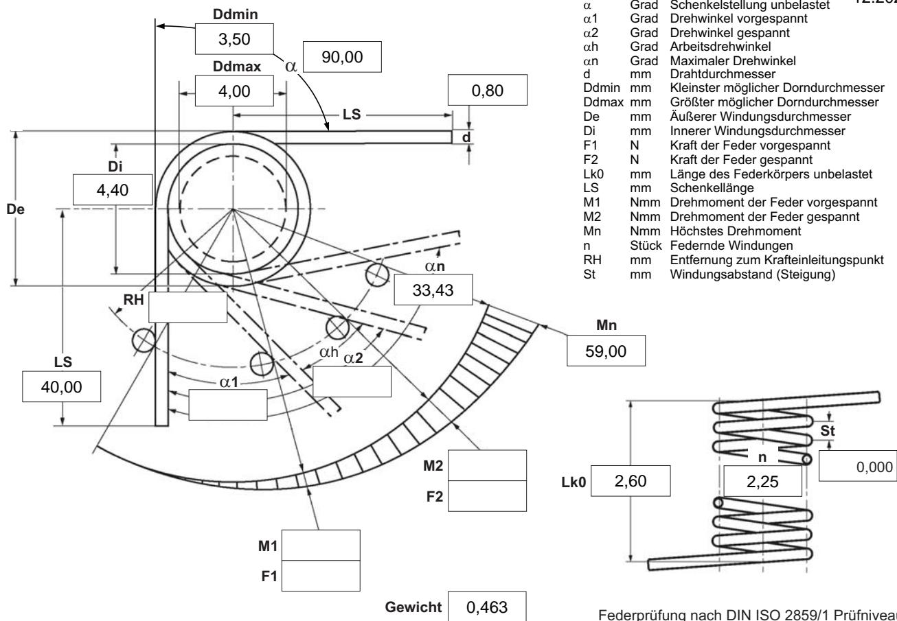
Federprüfung nach DIN ISO 2859/1 Prüfniveau II
