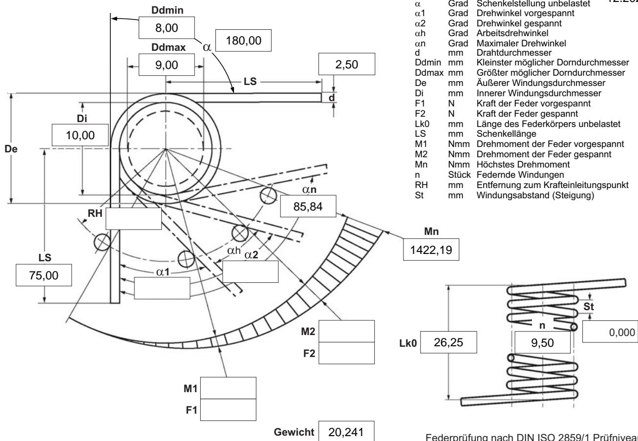
Federprüfung nach DIN ISO 2859/1 Prüfniveau II
